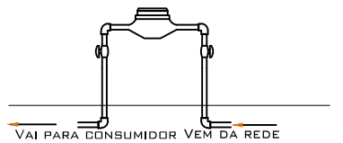
DETALHE DO HIDRÔMETRO
